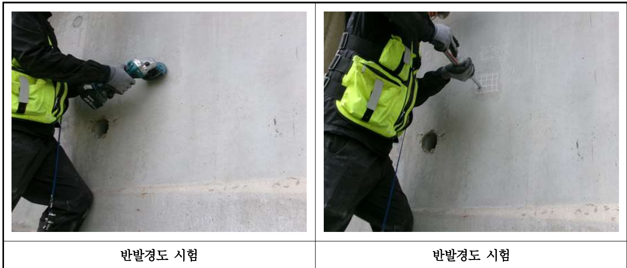
【사진 46.4.2】 반발경도시험 현장사진
